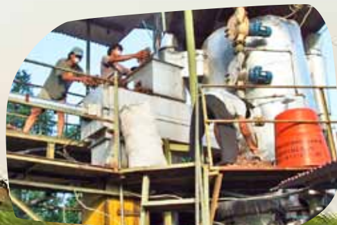
粘土を触媒としたバイオマスの流動接触分解ガス化実証プラント
